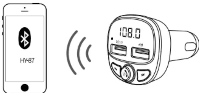
4. Ajuste la radio de su coche en FM y busque un canal FM desocupado. Ajuste la frecuencia FM en el transmisor Bluetooth FMT-B7 para que coincida con la frecuencia FM de la radio del coche.
