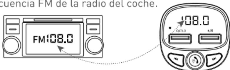
5. Ajuste la frecuencia del transmisor FM. Mantenga pulsado el botón multifunción hasta que la pantalla de frecuencia comience a parpadear. Pulse (icono de retroceso) o (icono de avance) y ajuste la frecuencia de transmisión FM para que coincida con la frecuencia FM de la radio del coche.
